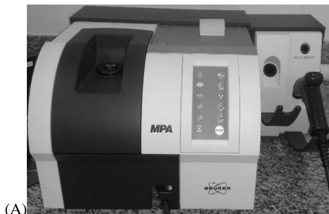
Figura 3 - Espectrofotômetro no NIRS por transformada de Fourier e a medição dos corpos de prova via esfera de integração (A) e via fibra óptica (B).
