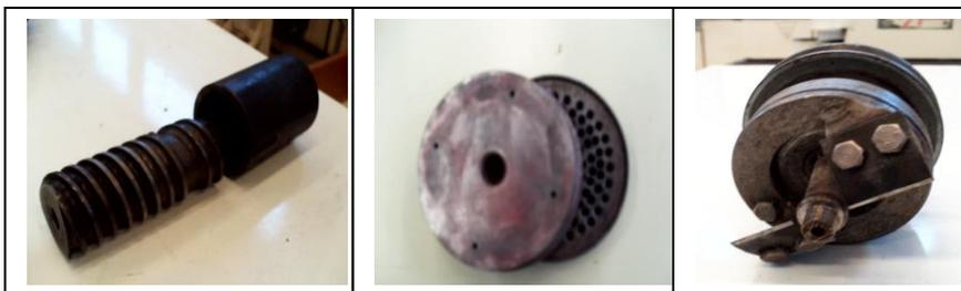
FIGURA 3 Parafuso e camisa; Matriz de quatro furos; e cortador.
