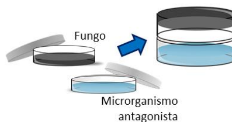
Figura 2.1 – Esquema de montagem das placas para avaliação dos metabólitos antifúngicos voláteis.
