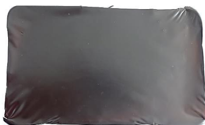
Figura 5 - Coloração do filme produzido com 1.5% de GOPN e 20% de glicerol (GOPN1.5G20).
