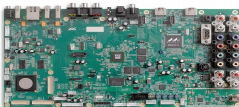
Figura 22: Circuito impresso Set-Top box com múltiplas funções. Fonte: www.ginga.com.br
