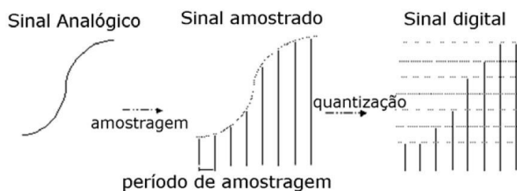
Figura 05 - Digitalização de um sinal analógico (MONTEZ E BECKER, 2005)
