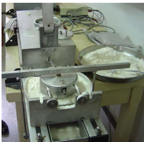
FIGURA 5 Foto da Jenike Shear Cell em ensaio de cisalhamento.
