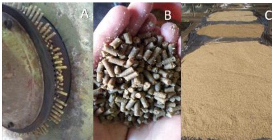
A- Peletizadora; B- pellets formados; C- secagem dos pellets.
