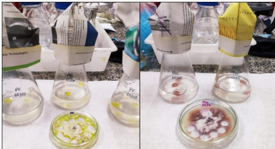
7. Os frascos então foram novamente fechados e posicionados em um *shaker*<sup>2</sup> por 7 dias a uma velocidade de rotação de 180rpm a uma temperatura de 30°C.
