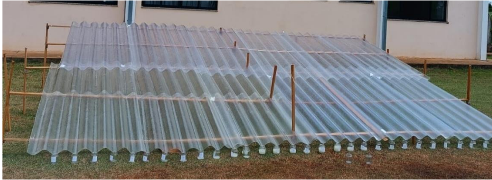
Figura 2 – Sistema de avaliação da distribuição volumétrica de pulverizações feitas por drones, constituído por 31 canaletas de fibra de vidro.
